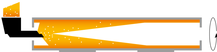
Abb. 1: Schematische Darstellung des Schleudergussverfahrens.
