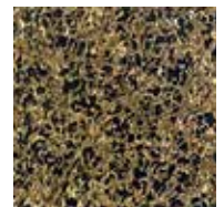
Abb.3: Ferritisch-karbidische Mikrostruktur des GL21.
