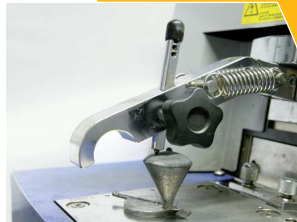
Abfunken einer Gussprobe mittels Spektralanalyse
