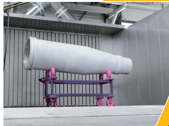
Dekanterbauteil während der zerstörungsfreien Prüfung
