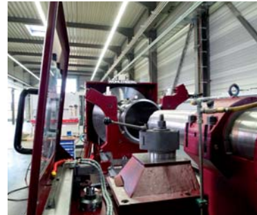
Auf CNC-gesteuerten Großdrehbänken findet die Zerspänung statt
