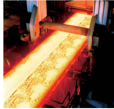
Stranggussrollen entstehen bei Kuhn Edelstahl im Verbund-Schleuderguss
