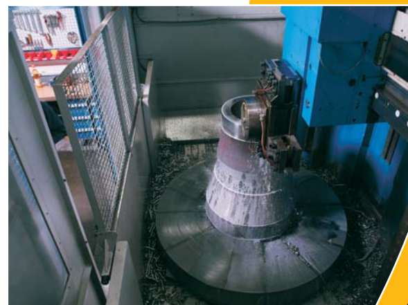
Optimale Bearbeitung eines Dekanterbauteils
