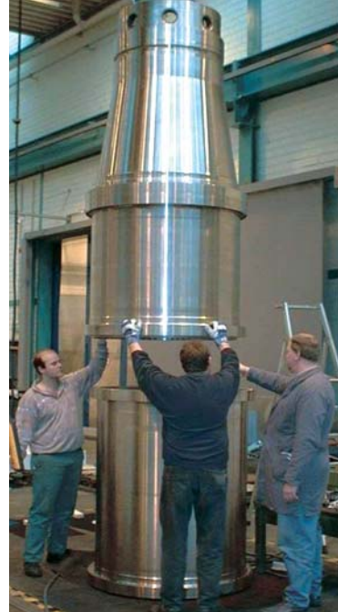
Montage eines Trommelmantels im Durchmesser 1.000 mm
